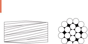
El Cable Inox. 8mm 1x19 es parte fundamental de los sistemas anticaída, proporciona seguridad y libertad de movimiento al usuario. El enlace con el Absorbedor y Tensor Overhead se realiza mediante ponchado.
