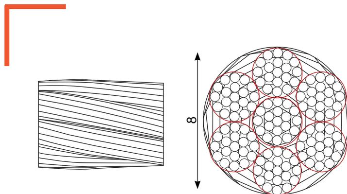
El Cable Inox 8mm 7x19 es parte fundamental de los sistemas anticaídas, proporciona seguridad y libertad de movimiento al usuario. El enlace con el Absorbedor, Tensor y Terminal de Horquilla se logra por ponchado.
