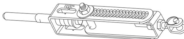
El Absorbedor se instala en un extremo de la línea de vida. El producto absorbe la energía de la caída y limita el daño a estructuras, está desarrollado para actuar de acuerdo con el principio de Absorción Instantánea de Energía (AIE) Scope Multi. De esta forma se reduce notablemente la fuerza sobre el sistema. También actúa como tensor y cuenta con indicador de tensión. La conexión al cable se logra por ponchado.
