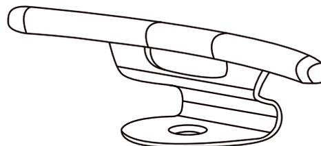
El Soporte Intermedio 45° está diseñado para ser instalado sobre el Cono. Es un soporte para el cable utilizado en esquinas de grados iguales o similares. Debido a su diseño el carro se desliza fácilmente a través de este sin necesidad de desconexión.
