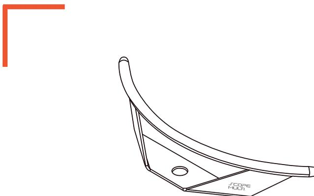
El punto intermedio 90° está diseñado para ser instalado sobre el Cono. Es un soporte para el cable utilizado en curvas pronunciadas. Debido a su diseño el carro se desliza fácilmente a través de este sin necesidad de desconexión.
