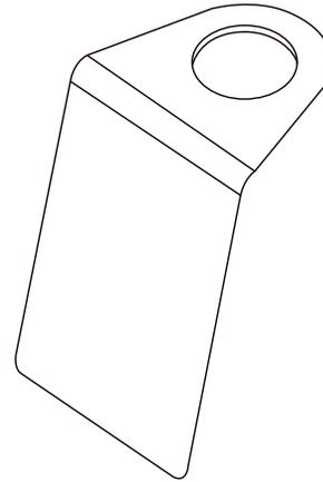
La Placa ID se instala para identificar la línea de vida y proporcionar la debida trazabilidad. El sticker tiene un revestimiento UV que garantiza su durabilidad.
