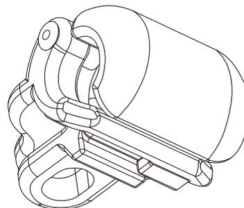
El Carro Scope Multi® es el elemento de conexión del usuario al sistema y ofrece un deslizamiento óptimo a través de toda su longitud. El carro permite que el usuario se conecte o desconecte en cualquier punto de la línea de vida, cuenta con un doble mecanismo de bloqueo y garantiza el más alto nivel de seguridad.
