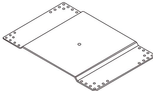
La Placa Base Cuadrada 500 para paneles metálicos perfilados o de junta alzada, ha sido diseñada para instalarse y fijarse a la superficie, de esta forma se protege la integridad del techo. La Placa Base Cuadrada 500 se fija con abrazaderas a juntas alzadas o con remaches a paneles metálicos perfilados.
