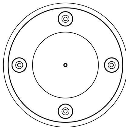
La Placa Base Redonda para techos con membrana ha sido diseñada para su instalación sobre la superficie y su fijación a la estructura. De esta forma se protege la integridad del techo, su forma circular proporciona libertad a la hora de instalarla.
