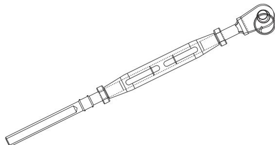
El Tensor está diseñado para que sea una pieza permanente de interconexión entre el cable y los Soportes Extremos, cuenta con un sistema de ajuste de la tensión del cable por medio de rotación y se bloquea con tuercas una vez se logra la tensión deseada. La conexión al cable se logra por punchado.
