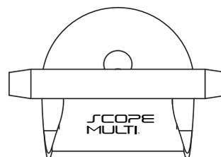
El Soporte Intermedio de Pared es un punto de apoyo para el cable utilizado en intervalos específicos. Debido a su diseño especial el carro desliza fácilmente a través de este sin necesidad de desconectarlo de la línea de vida.
