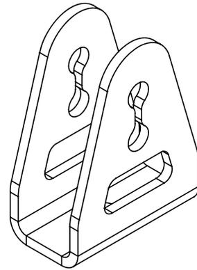
El Soporte Extremo Overhead es la conexión entre la línea de vida y la estructura. Está diseñado para instalación en vigas y estructuras metálicas / concreto de suficiente resistencia. El Soporte Extremo es giratorio y está siempre en línea con el cable, de esta forma reduce la fuerza cortante en caso de una caída.
