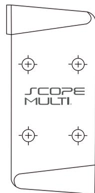
El Soporte Intermedio Vertical se coloca a intervalos específicos, reduce el movimiento del cable y se requiere solo de una mano para pasar el carro a través de este.
